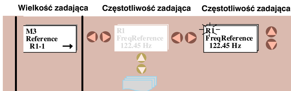
Rysunek 7-8. Ustawianie wielkości zadających na panelu sterującym
