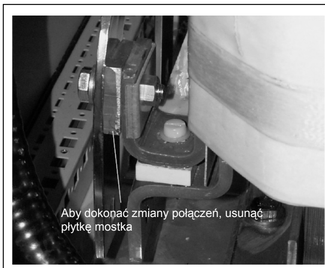
Rysunek 5-6. Odczepy wejściowe dławika w przemiennikach wielkości FR13/14..
